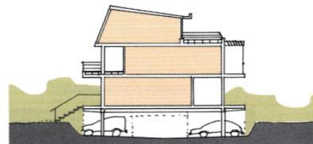
▲ A demi encaissé, le garage collectif à dessertes centrales se glisse sous l'emprise de l'immeuble et préserve le rapport du bâtiment au sol
